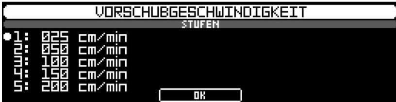
Jede der 5 Vorschubstufen ist mit einer Geschwindigkeit vorbelegt. In der Abbildung oben sehen Sie die Standardbelegung.
