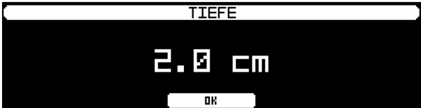
Die Tiefe wird durch Drehen des Navigationsknopfes eingestellt. Das Einstellmenü wird durch kurzes Drücken der roten Taste im Hauptmenü aufgerufen.
