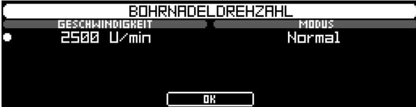
Im normalen Modus kann die Bohrnadeldrehzahl zwischen 1.500 U/min und 5.000 U/min eingestellt werden.
