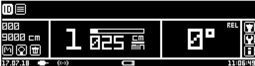
Um den Relativmodus wieder auszuschalten, halten Sie beide Tasten und den Sicherheitstaster gedrückt, bis ein Signal ertönt. Der Text **REL** wird nicht mehr angezeigt.
