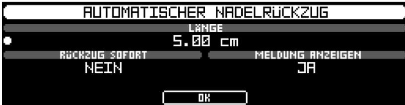
Über die Option **LÄNGE** wird festgelegt, welche Länge der Hohlraum mindestens haben muss, damit der automatische Nadelrückzug aktiviert wird.
