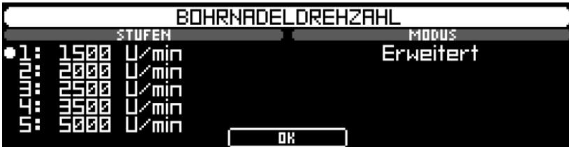
Jede der 5 Drehzahlstufen ist mit einer Geschwindigkeit vorbelegt. In der Abbildung oben sehen Sie die Standardbelegung.
