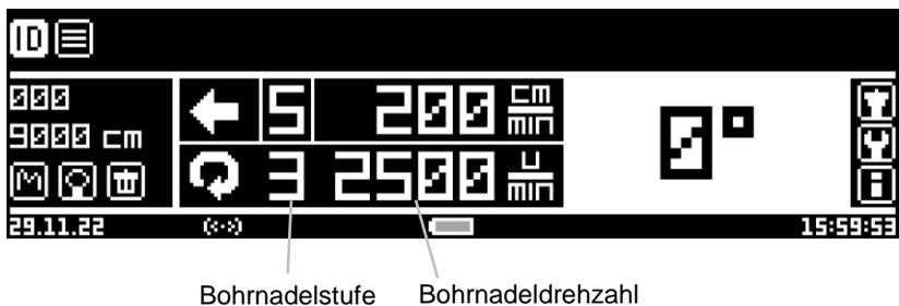
Im erweiterten Modus wird zusätzlich die Drehzahl der Bohrnadel angezeigt. (s. 4.17.4)
