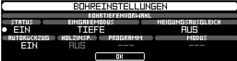
Mit Hilfe der Funktion **BOHRTIEFENVORWAHL** kann festgelegt werden, wie tief das Gerät bohren soll (siehe 4.6.1). Wird die eingestellte Tiefe erreicht, so wird es automatisch zurückgezogen.
