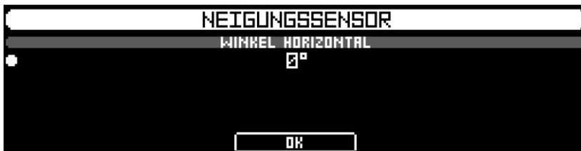
Mit der Option **WINKEL HORIZONTAL** kann festgelegt werden, ob als Winkel  $0^\circ$  oder  $90^\circ$  angezeigt wird, wenn das Gerät horizontal ausgerichtet ist. Wird  $0^\circ$  eingestellt, so erfolgt die Anzeige im Bereich  $-90^\circ$  (Gerät nach vorne geneigt) bis  $+90^\circ$  (Gerät nach hinten geneigt). Wird  $90^\circ$  eingestellt, so erfolgt die Anzeige im Bereich  $0^\circ$  (Gerät nach vorne geneigt) bis  $180^\circ$  (Gerät nach hinten geneigt).
