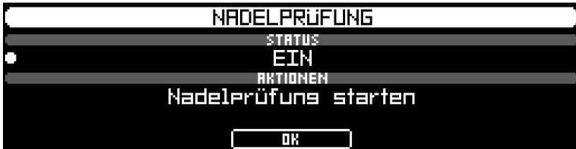
Die Option **STATUS** gibt an, ob die Nadelprüfung ein- oder ausgeschaltet ist. Bei eingeschalteter Nadelprüfung wird die Bohrnadel am Anfang eines Bohrvorganges geprüft und der Status ausgegeben. Das Ergebnis (gut oder schlecht) wird zusammen mit der Messung abgespeichert und nach dem Übertragen zum Computer in PD-Tools angezeigt.
